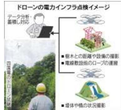
送電線と樹木の接触を避けるための定期的な離隔測定では、ドローンの撮影画像を複数組み合わせ、3次元データにして対応できる。このほか、送電線の新設時など、電線を渡す前に張る細いパイロットロープを運ぶ役割も想定。子会社の四国総合研究所などが研究・試験に協力する。
