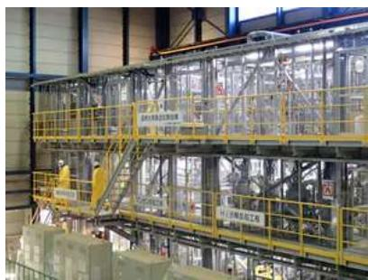
高温を利用した化学反応を組み合わせ、水から水素を作る(茨城県大洗町にある原子力機構の設備)
