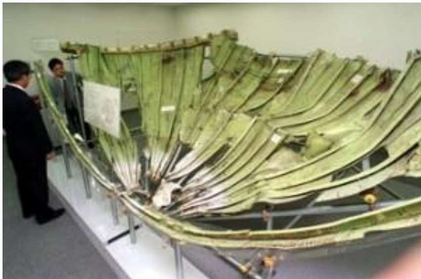
事故現場から回収した圧力隔壁の損傷状態
